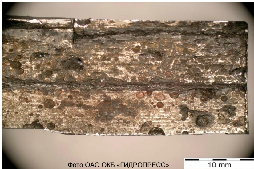
Коррозионные повреждения внутренней поверхности “кармана” на переходном кольце коллектора ПГВ-1000
